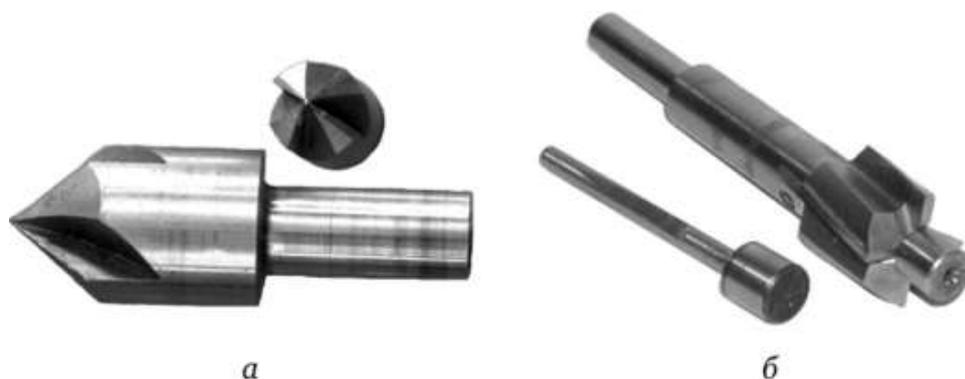
Рисунок 5 - Зенковки: а — конические; б — торцовые
